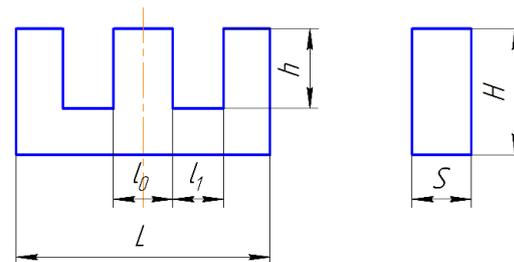
**Условное обозначение Ш-образных сердечников замкнутых при заказе и в конструкторской документации** должно состоять из слов «сердечник замкнутый», сокращенного обозначения изделия, типоразмера, коэффициента индуктивности (нГн) для сердечников с зазором, группы точности (для II группы) и обозначения технических условий.
