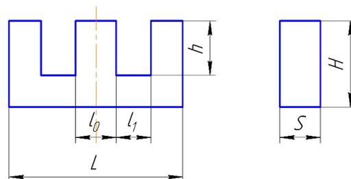
**Условное обозначение сердечников замкнутых Ш-образных при заказе и в конструкторской документации** должно состоять из слов «сердечник замкнутый», сокращенного обозначения, типоразмера, группы точности (для II группы) и обозначения технических условий.
